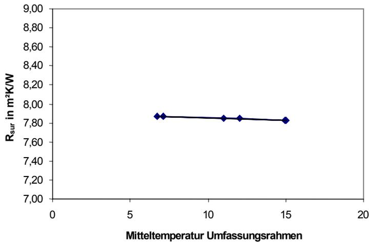
**Bild 2** Wärmedurchlasswiderstand Umfassungsrahmen
